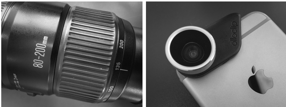
Abbildung 22: Links: Zoomobjektiv mit Brennweiten von 80-200mm / rechts: Aufsteckbare Weitwinkellinse für ein Smartphone (Fotos: Hanspeter Füllemann)
