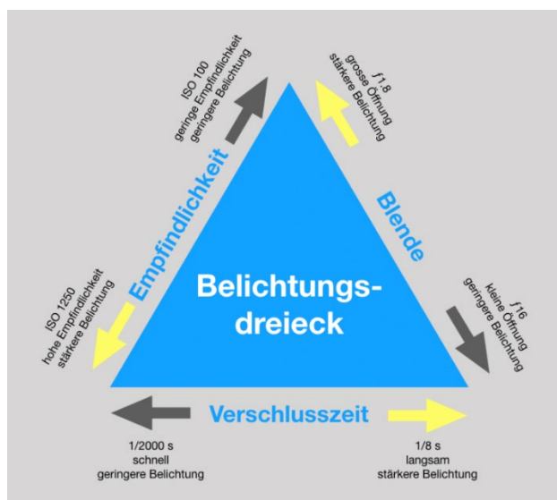
Abbildung 15 Das Belichtungsdreieck (Darstellung: Hanspeter Füllemann)
