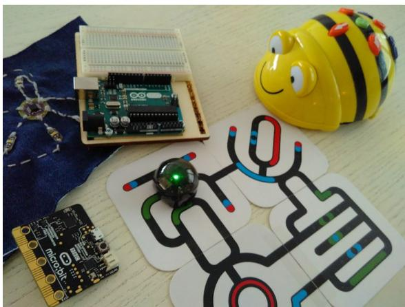
*Abbildung 10: Informatiksysteme für die spielerische Erkundung von Informatikkonzepten: «Arduino Uno» (oben links), «Bee-Bot» (oben rechts), ein «Ozobot» fährt entlang den bunten Linien, «micro:bit»-Platine (unten links) und «Lilypad Arduino» auf Stoff aufgenäht. (Bettina Waldvogel)*
