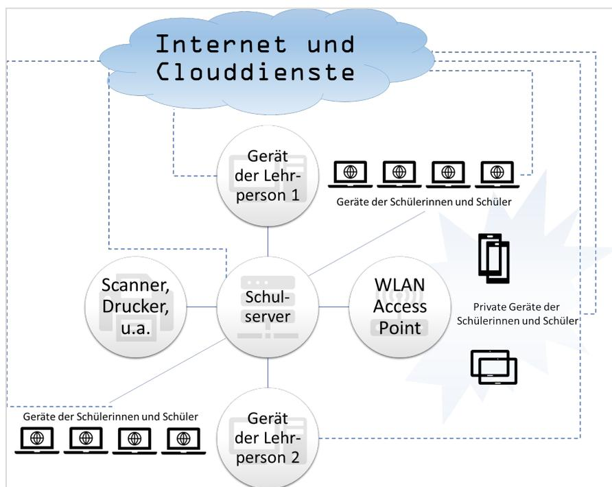
Abbildung 4: Client-Server-Architektur einer Schule mit zwei Schulzimmern mit je einem Lehrercomputer und Schülergeräten, einem Server, einem gemeinsam genutzten Drucker und Internetzugang zu Cloud-Diensten. Smartphones und Tablets sind über WLAN verbunden. (Andrea Gumpert nach Vorlage von Bettina Waldvogel)
