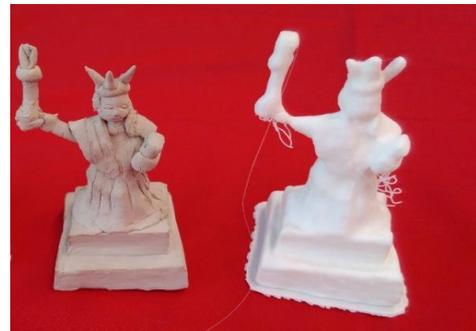
Abbildung 4: Die Tonfigur (links) wurde gescannt und mit einem 3D-Drucker ausgedruckt (rechts).
