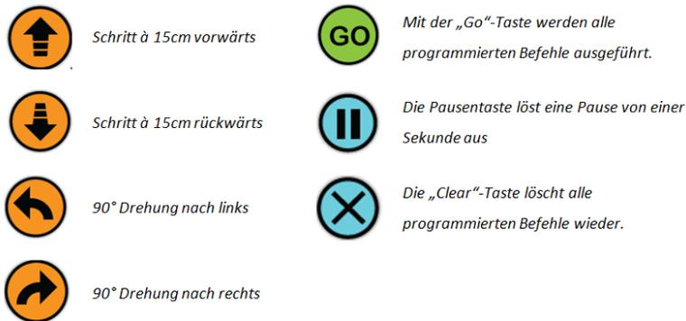
Abbildung 6: Steuerungsbefehle des Bee-Bots<sup>16</sup>
