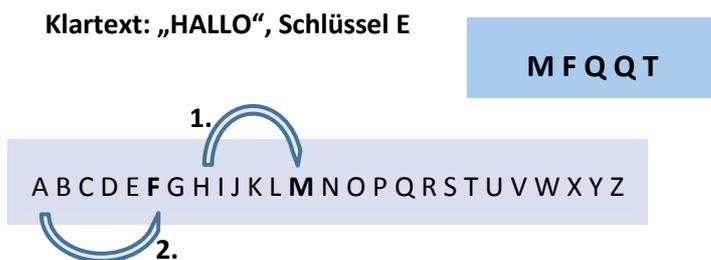
Abbildung 8: Caesar-Verschlüsselung der ersten zwei Buchstaben des Wortes „HALLO“ mit dem Code E, d.h. mit einer Verschiebung um fünf Buchstaben. H wird zu M, A wird zu F, L wird zu Q und O wird zu T.
