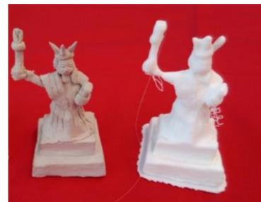
Abbildung 5: Die Tonfigur (links) wurde gescannt und mit einem 3D-Drucker ausgedruckt (rechts).
