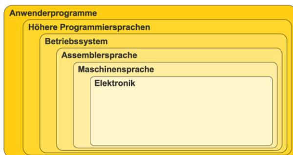
Abbildung 10 Schalenmodell eines Computers (Schaller, 2016)
